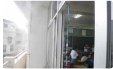
水噴霧冷却(ミスト) 微細な水滴(ミスト)を噴霧し、その水滴が蒸発することで周りの空気の温度を下げる効果を検証した
